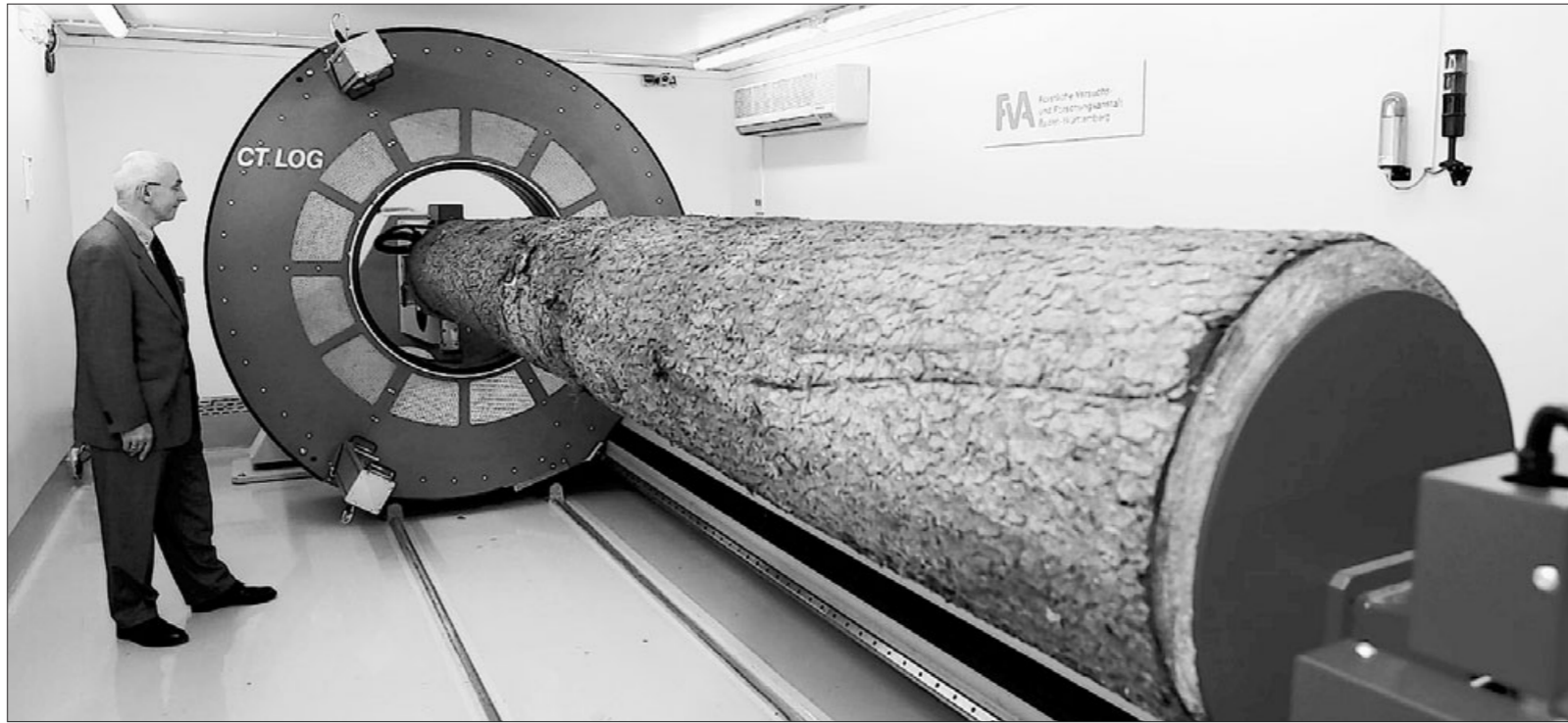
Magnetwellen statt Kettensäge: Mit einem Computertomographen blicken Forscher der Forstlichen Versuchsanstalt in Freiburg ins Innere der Baumstämme. Foto: dpa
